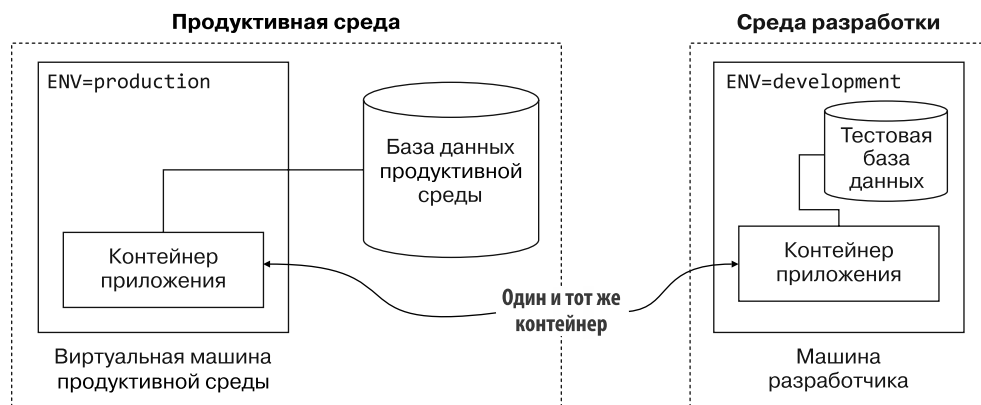
Рис. 1.5. Развертывание одного и того же контейнера в продуктивной среде и среде разработки
