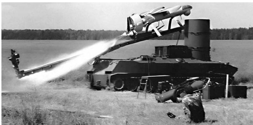
Рис. 3.10. Старт разведывательного БПЛА «Пчела»
