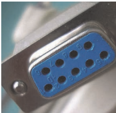
Рис. 1.1 Розетка 9-контактного разъема COM-порта
