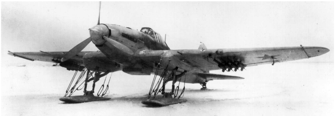
Ил-2 с неубирающимся лыжным шасси. Государственные испытания, январь 1942 г.
