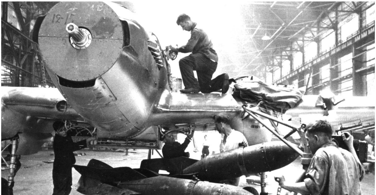
Монтаж и отработка вооружения на Ил-2, 3-д №30
