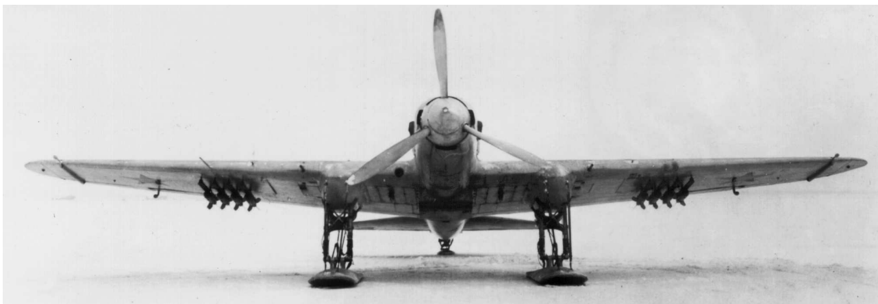
Ил-2 с неубирающимся лыжным шасси. Вид спереди
