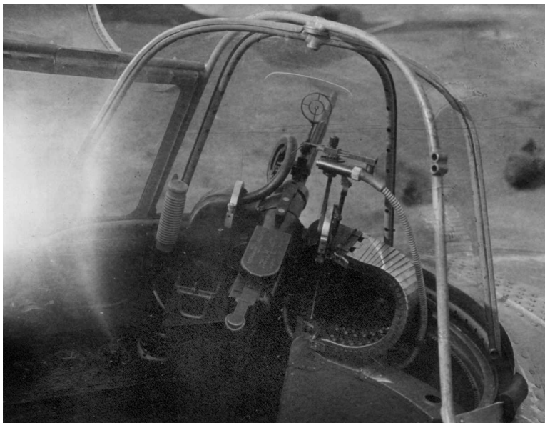
Стрелковая оборонительная установка штурмана-стрелка на БШ-2
