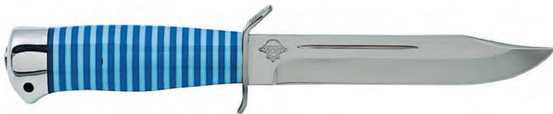
В 1943 году гарда, рукоять и ножны НА-40 претерпели значительные изменения, и советские разведчики получили на вооружение еще более удачную конструкцию — нож НР-43 с прямой гардой, кожаными ножнами и прочной пластмассовой рукоятью, увен-
