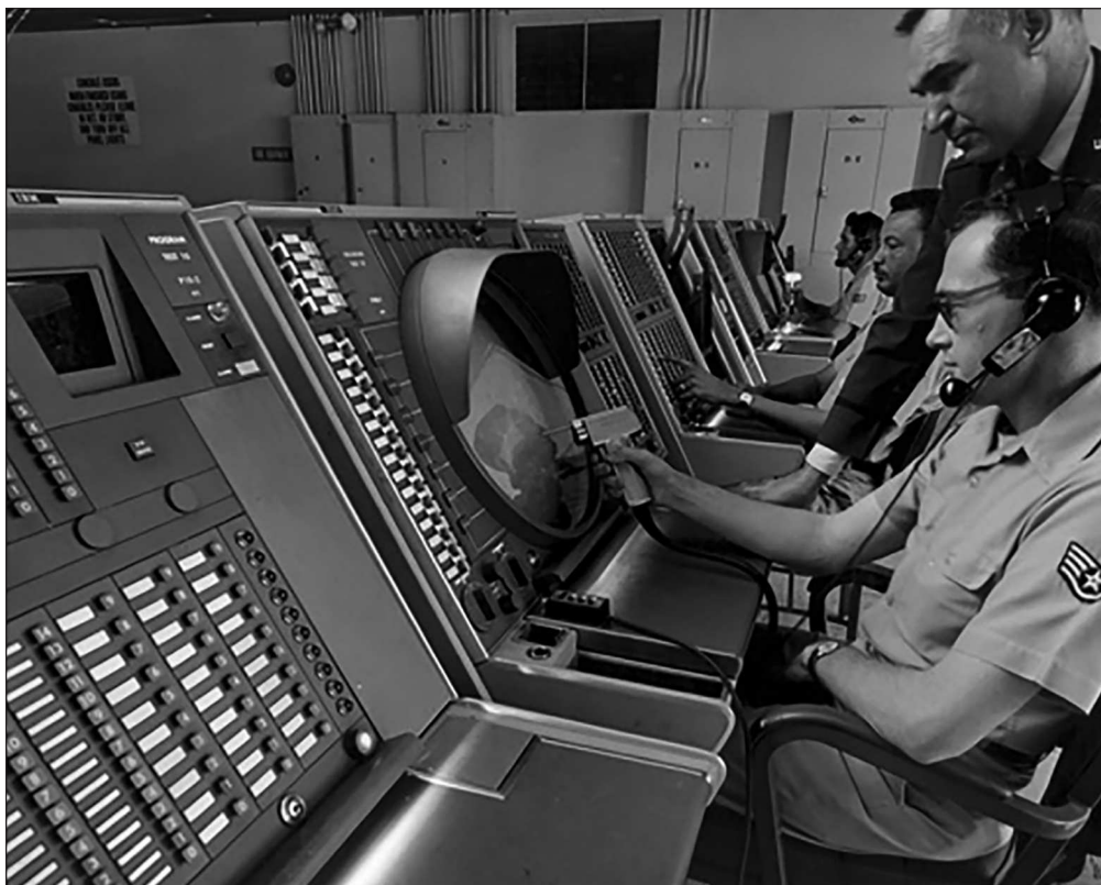
Наземный пост управления полуавтоматической системой ПВО Американского континента
