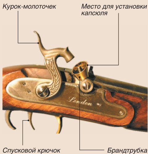
Устройство капсюльного замка.
