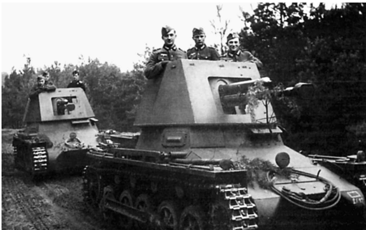
Немецкая противотанковая САУ Panzerjäger I с 47-мм чехословацкой пушкой
