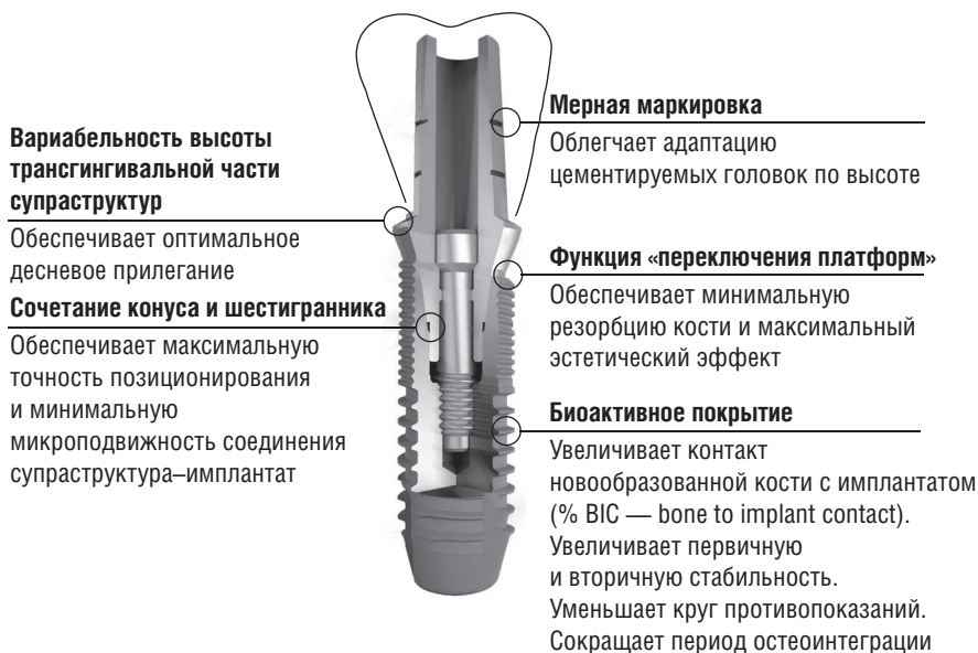
Рис. 13. Разновидность супраструктура–имплантат на примере имплантата КОНМЕТ
