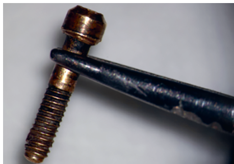
Рис. 17. Клинический винт для фиксации абатмента
