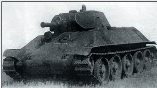
Опытный средний танк А-32 (первый образец) во время полигонных испытаний летом 1939 года
