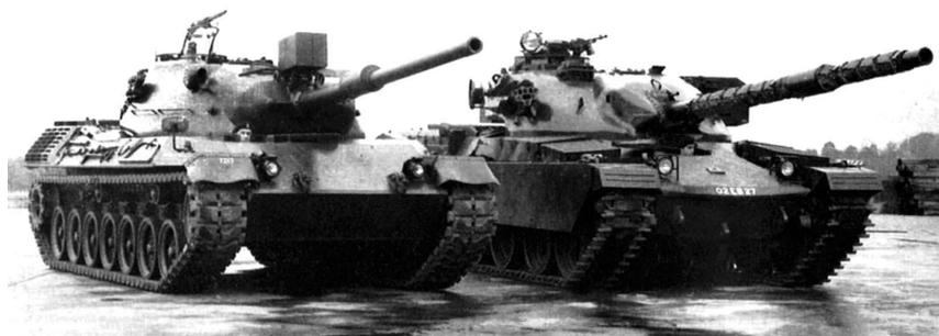
нашался двенадцатицилиндровым четырехтактным бензиновым двигателем и пятиступенчатой коробкой передач, которые позволяли машине развивать максимальную скорость до 65 км/ч. В качестве основного оружия в комплексе вооружения танка использовалась французская 105-мм танковая пушка.
