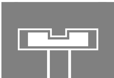
Рис. 28. Антенна с подачей сигнала на монополь через зазор
