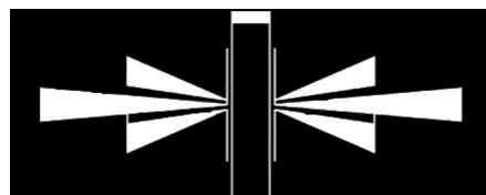
Рис. 14. Спаренные щелевые антенны
