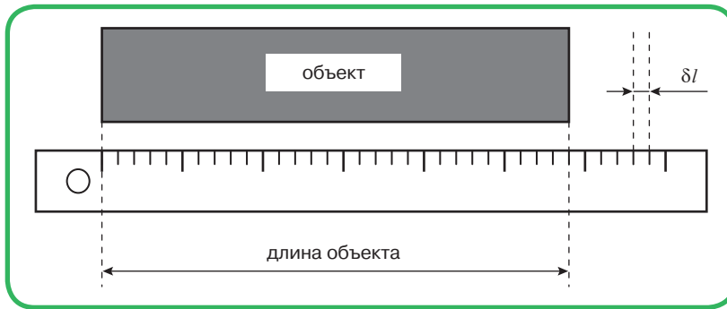
Рис. 2.3. Объяснение процесса измерения длины объекта
