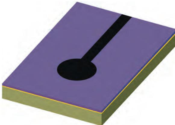
Рис. 1.8. Позитивный фотошаблон на покрытой фоторезистом плате
