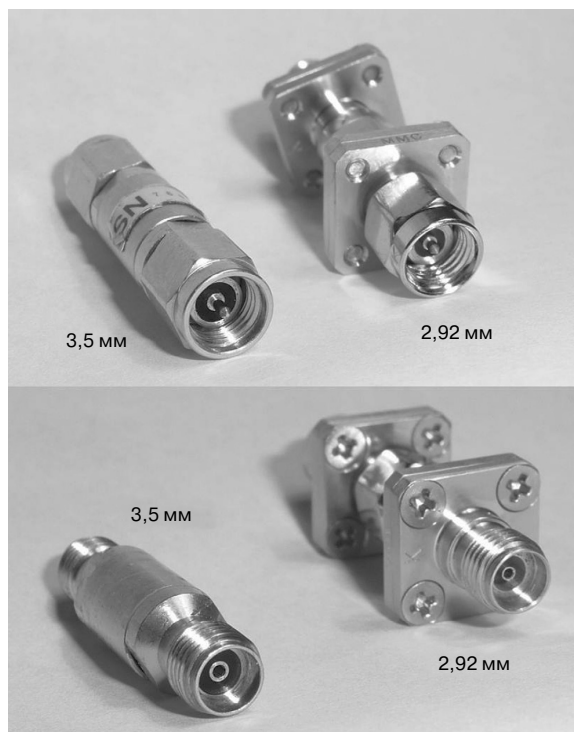
Рис. 1.23. Переходы с соединителями 3,5 мм (слева) в сравнении с 2,92 мм, вилка и розетка
