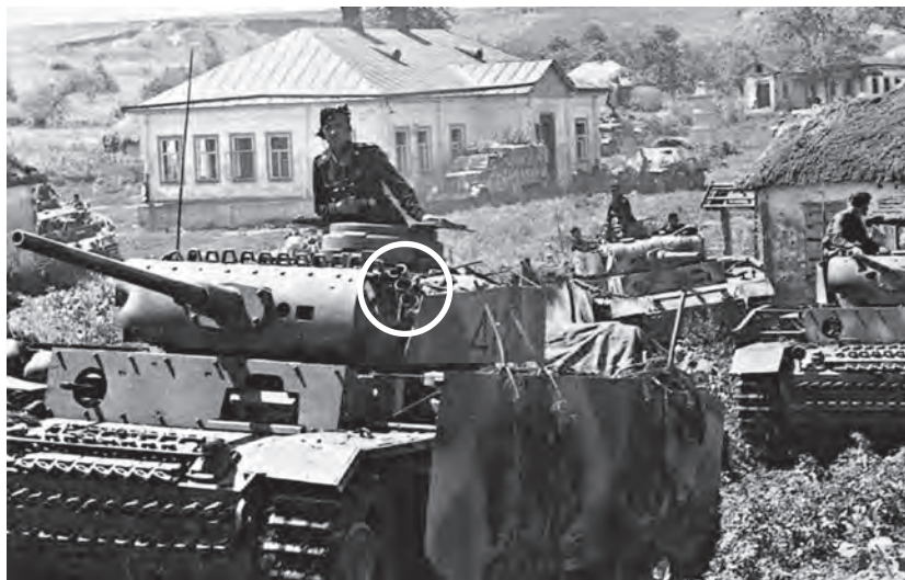
Немецкие экранированные средние танки PzKpfw III на Курской дуге перед началом операции «Цитадель». На башне первого танка с правой стороны установлены гранатометы NbK 39-калибра 90 миллиметров для постановки дымовых завес
