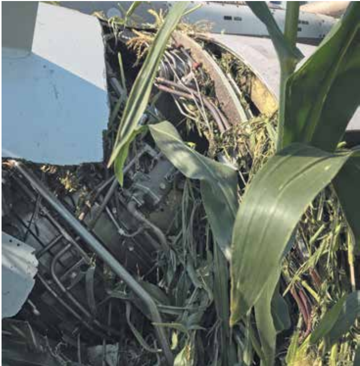
Поврежденный при посадке левый двигатель Airbus A321 VQ-BOZ
