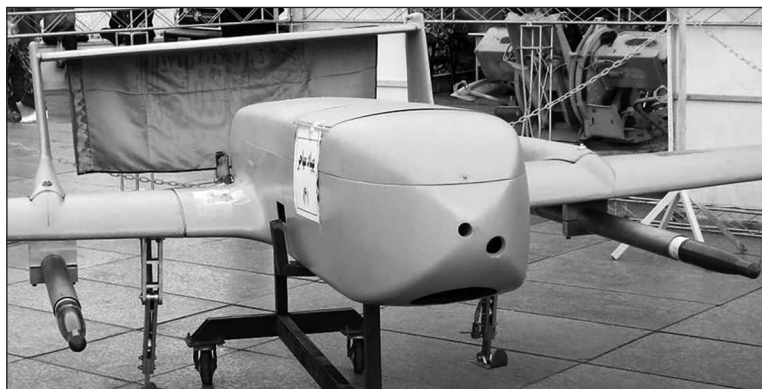
БПЛА «Мохаджер-4» с подвешенными НАР «Гидра» калибра 70 мм
