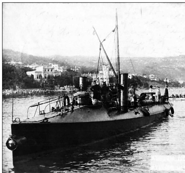
Миноносец Тб XX в 1905 г. Корабль прошел модернизацию, в ходе которой два носовых ТА заменены на один
