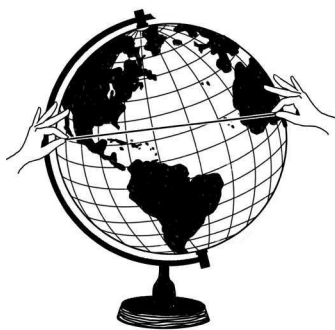
Рис. 3. Простой способ отыскания действительно кратчайшего пути между двумя пунктами: надо на глобусе натянуть нитку между этими пунктами
