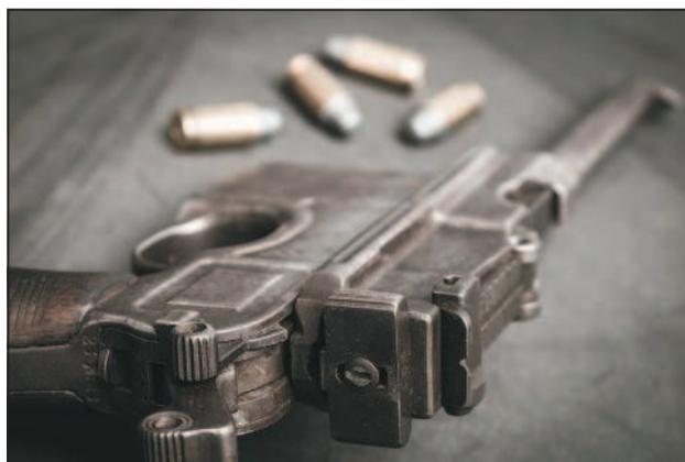
*Пистолет снабжен ударным механизмом куркового типа с открытым расположением курка. Спусковой механизм большинства модификаций пистолета допускает ведение лишь одиночного огня (исключение — «Модель 712»).*
