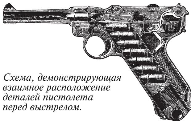
*Схема, демонстрирующая взаимное расположение деталей пистолета перед выстрелом.*
