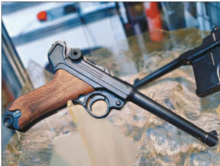
*LP-08 — так называемая артиллерийская модель. Этот пистолет имел общую длину 327 мм (длину ствола 200 мм), вес без патронов 1000 г и начальную скорость пули 370 м/с. Он предназначался для вооружения расчетов орудий и младших офицеров пулеметных команд. LP-08 с приставной деревянной кобурой-прикладом позволял вести прицельный огонь на расстояние до 800 м. Емкость магазина была стандартной — восемь патронов, но мог применяться и дисковый магазин системы Леера емкостью 32 патрона.*
