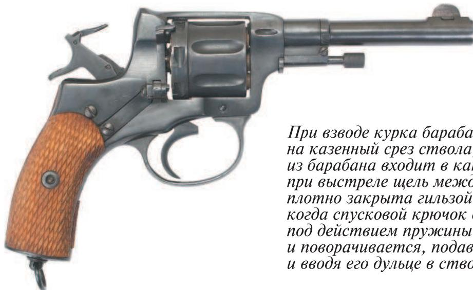
*При взводе курка барабан надвигается на казенный срез ствола, и дульце гильзы из барабана входит в канал ствола. Поэтому при выстреле щель между барабаном и стволом плотно закрыта гильзой. После выстрела, когда спусковой крючок отпускают, барабан под действием пружины отходит назад и поворачивается, подавая следующий патрон и вводя его дульце в ствол.*
