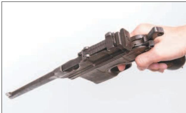
*Пистолеты Маузера снабжались переменными прицелами секторного типа с насечкой до 1000 м, при этом шкала прицела была нанесена через каждые 50 м до дистанции 500 м и через 100 м на дистанции от 500 до 1000 м.*
