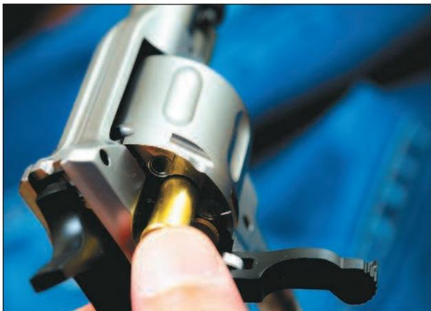
*В процессе перезаряжания револьвера стрелок шомполом по одному выталкивал использованные патроны из камер барабана. Лишь после этого можно было приступить к заряданию — медленно поворачивая барабан, вложить в камеры семь патронов.*
