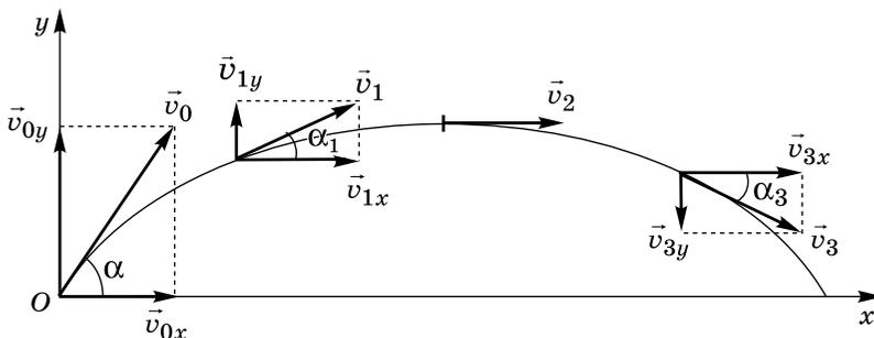
В вершине параболы вертикальная составляющая скорости  $v_{2h}$  равна нулю. В точке падения скорость тела равна по абсолютной величине скорости тела в точке бросания, а направление её составляет тот же угол, что и в точке бросания (взятый с обратным знаком). Это следует из симметрии параболы и имеет место в отсутствие сопротивления воздуха.
