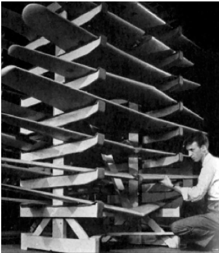
Компания Боинг потратила тысячи часов на испытания различных аэродинамических профилей и создала сотни различных конструкций крыльев, из которых они выбрали лучшие для применения на В-29. На фото — стеллажи с различными моделями крыльев в аэродинамической лаборатории Боинг
