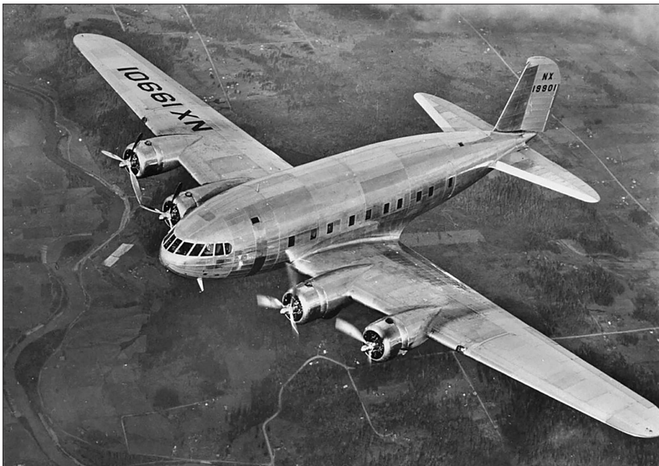
Четырёхмоторный пассажирский самолёт Боинг Модель В-307 Стратолайнер стал первым в мире высотным самолётом с герметичным фюзеляжем. Обратите внимание на отсутствие «ступеньки» в конструкции остекления пилотской кабины. Этот лайнер задал высокие стандарты пассажирских перевозок для всех последующих конструкций самолётов
