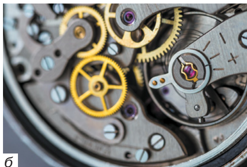
Рис. 1.3. Примеры механизмов: а — использование рычага при подъёме грузов; б — использование рычага в часовом механизме
