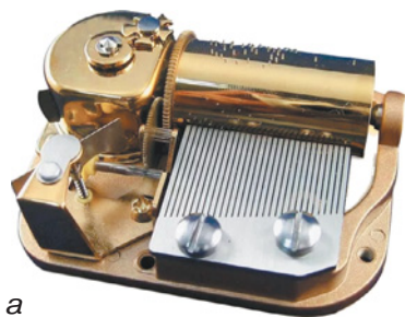
Рис. 1.4. Автоматы: а — внутренний механизм музыкальной шкатулки; б — часы с кукушкой
