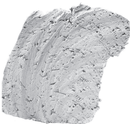
Образец глины с 40% шамота размером от 0 до 2 мм
