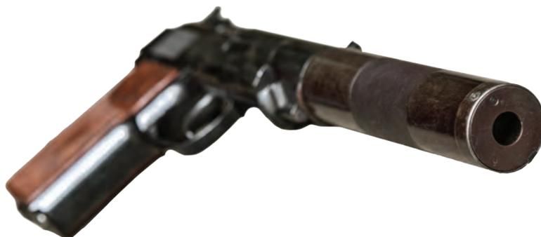
**УСМ (ударно-спусковой механизм):** двойного действия (выстрел можно произвести как предварительно взведя курок, так и обычным нажатием на спусковой крючок)
