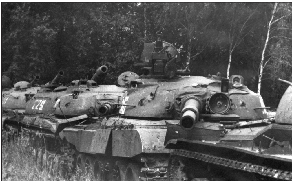
В запаснике кубинского музея находится еще один промежуточный прототип между Т-64 и Т-72. В этом ракурсе — практически Т-64
