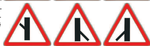
2.3.2–2.3.7 Примыкание второстепенной дороги
