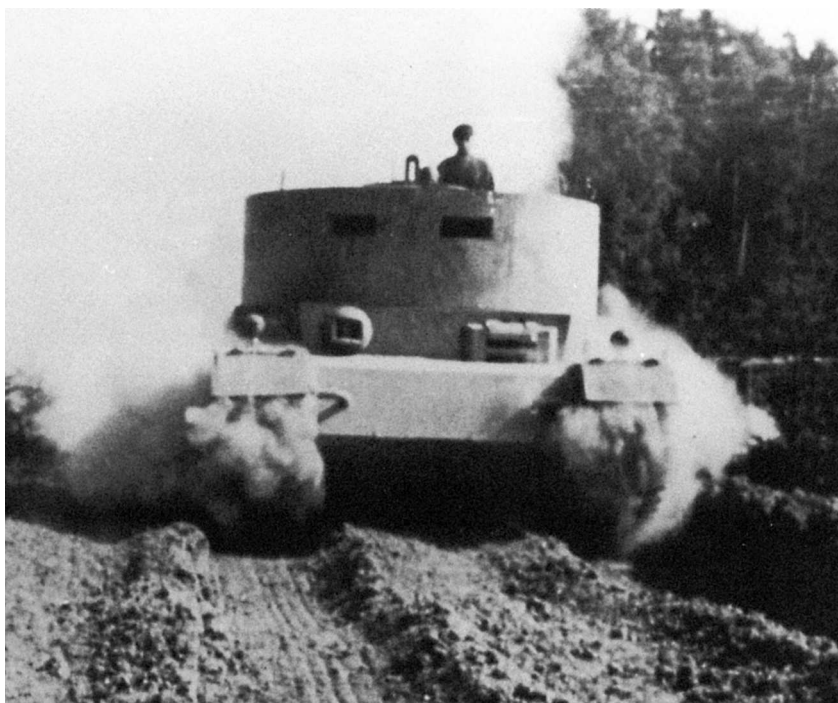
Прототип VK4501(P) с балластной рубкой вместо башни на испытаниях в Растенбурге
