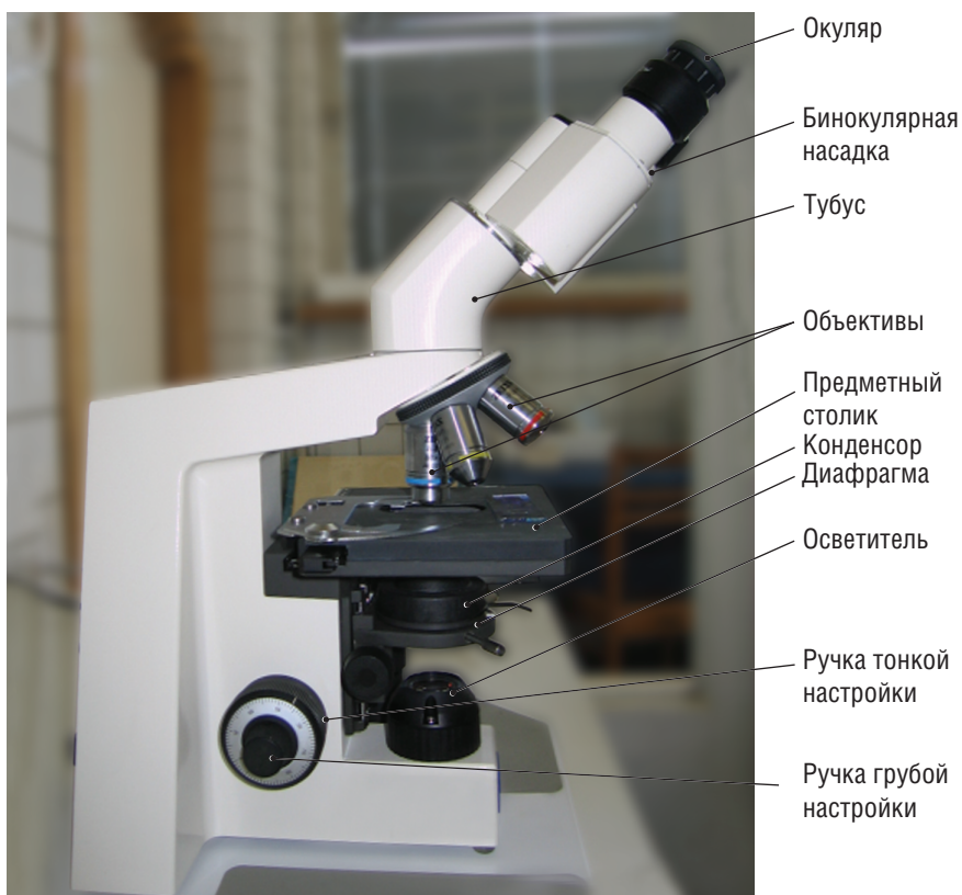
Рис. 2. Устройство микроскопа
