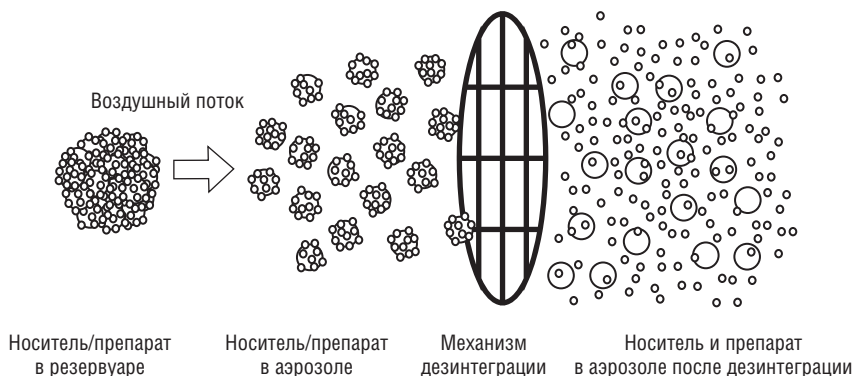
Рис. 6.10. Схема дезинтеграции микронизированных частиц препарата от кристаллов носителя с помощью дезинтегрирующего устройства
