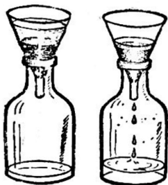
Рис. 4. Как вода протекает через глину и песок. Слева опыт с глиной, справа — с песком.
