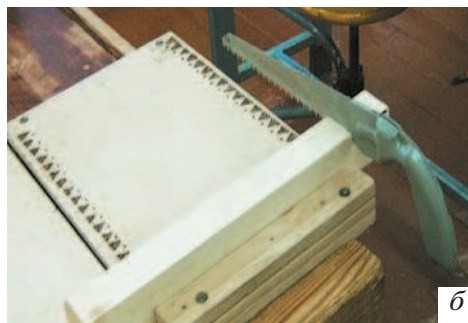
Рис. 1.6. Подкладная доска для столярного верстака: а — рабочий вариант; б — процесс пиления деревянного бруска на подкладной доске
