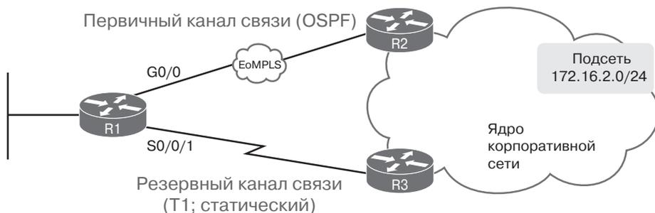
Рис. 18.16. Использование плавающего статического маршрута к подсети 172.16.2.0/24
