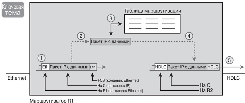
Рис. 18.2. Пять этапов маршрутизации, осуществляемых маршрутизатором
