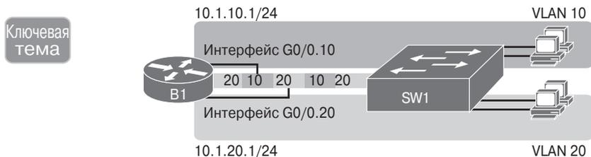
Рис. 18.12. Субинтерфейсы на маршрутизаторе B1
