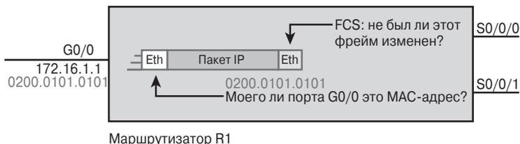
Рис. 18.5. 1-й этап маршрутизации: проверка FCS и MAC-адреса получателя
