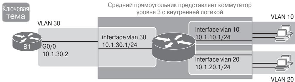
Рис. 18.13. Маршрутизация на интерфейсах VLAN коммутатора уровня 3
