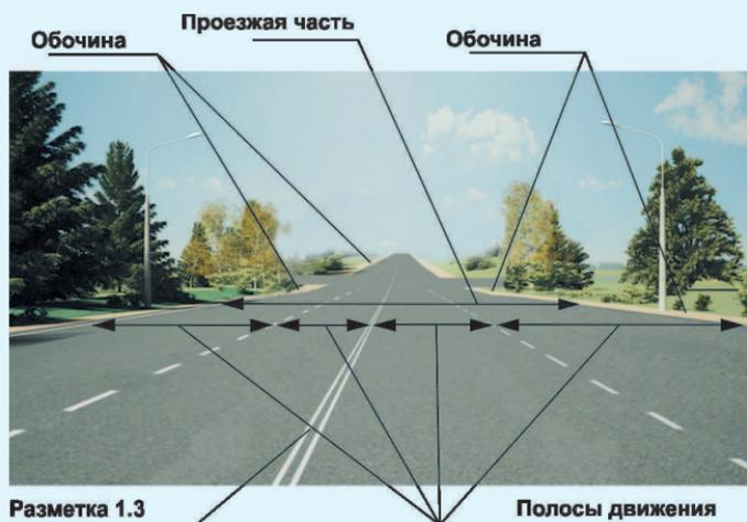
*Устройство дороги. Выделены проезжие части, разделительные полосы, полосы движения транспортных средств в обоих направлениях, обочины*
