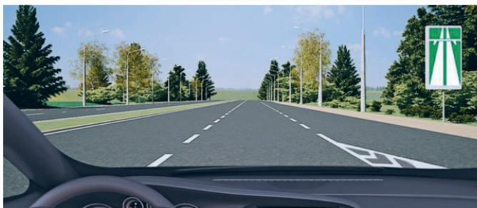
Автомагистраль – в данном случае дорога, обозначенная знаком 5.1, с тремя полосами движения в одном направлении и конструктивно выделенной разделительной полосой. Справа видна разметка 1.16.3, обозначающая слияние проезжих частей
