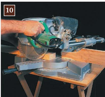
Торцовочно-усорезная дисковая пила с протяжкой обеспечивает максимальные возможности пиления среди всех электрических торцовых пил. Двигатель перемещается к оператору, затем опускается на заготовку и режет в процессе возврата в исходное положение.
