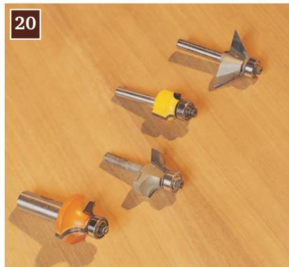
**Профильные (фигурные, фасонные) фрезы** используются для вырезания фигурных кромок на краях сидений, подлокотниках и кромках столешниц. Полезные калевочные фрезы включают: радиус 10 мм; радиус 6 мм; радиус 3 мм; используется также конусная фреза.
