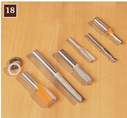
**Прямые фрезы (слева направо):** 19 мм, двухфрезевидная (двухканавочная); 75 мм длина, 12 мм диаметр, двухфрезевидная; 12 мм, двухфрезевидная; 12 мм, двухфрезевидная; 9,5 мм, 12 мм, двухфрезевидная; 6 мм, спиральная твердосплавная; 6 мм, твердосплавная с хвостовиком 12 мм. Подшипники слева ставятся на хвостовики 12 мм.
