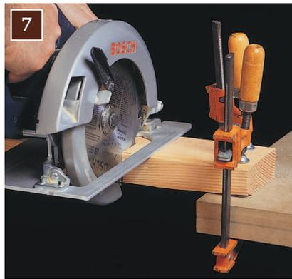
**7** Закрепление короткой заготовки, как показано здесь, освобождает обе руки для управления пилой. При любой возможности работайте дисковой пилой двумя руками. Это наиболее безопасный метод работы, который дает и наиболее точный результат.
