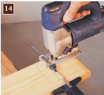
**14** Боковой направляющий упор является недорогим аксессуаром, который очень удобен для пиления параллельно кромке. Упор крепится к основанию лобзика. Упор скользит вдоль кромки заготовки и радикально облегчает продольное пиление.
