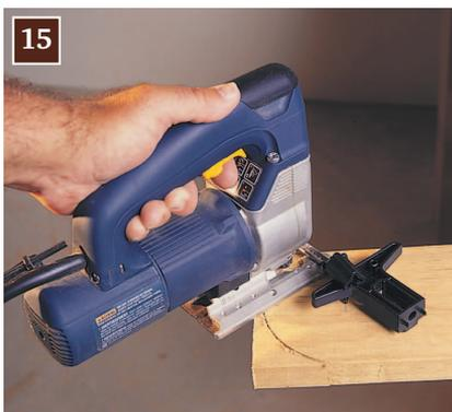
**15** Самые лучшие боковые упоры часто включают в конструкцию центровочный шип, так что они могут использоваться как циркуль, направляющий рез лобзика по окружности. Всего один центровочный шип — и вы ведете лобзик по заданной окружности.
