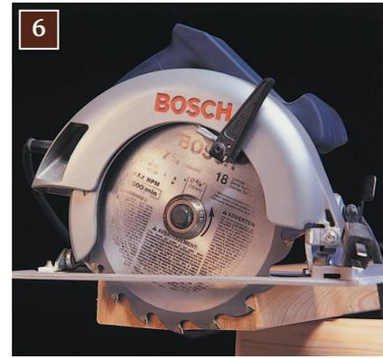
**6** Правильная глубина пиления — на 3 мм (1/8 дюйма) ниже нижней поверхности заготовки — минимизирует отдачу пилы за счет уменьшения поверхности диска, находящейся в пропилах. Это также уменьшает открытую часть диска, если все же произойдет отдача.
