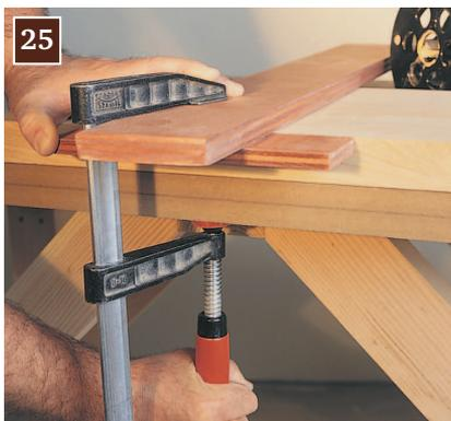
**25** Один правильно расположенный зажим — это все, что требуется для надежной фиксации таврового угольника на заготовке и заготовки на верстаке (рабочем столе). Прижмите поперечину угольника к кромке заготовки, переместите упор в нужное положение, затем зажмите.
