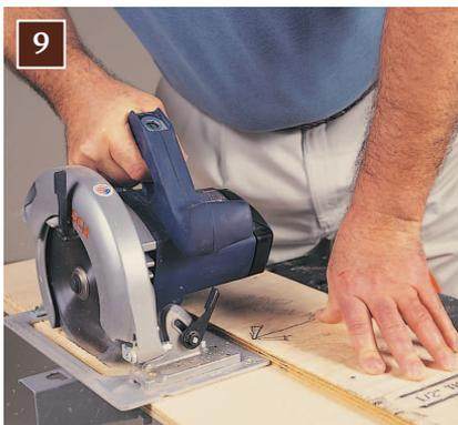
Закончите изготовление шаблона, опилив широкую полосу вашей дисковой пилой до нужной ширины. Просто поставьте основание пилы на основание шаблона, прижав кромку основания пилы к направляющей линейке, как показано на фото. Отпилите излишек, и ваш шаблон готов к работе.
