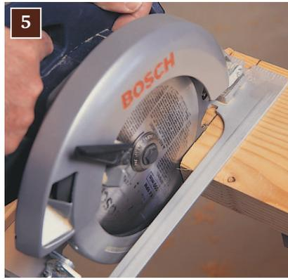
**5** Дисковая пила выполняет прямое пиление, и, начав пилить, трудно изменить направление реза. Выровняйте вырез в основании пилы по линии разметки и направляйте рез, следя за пильным диском или за вырезом.
