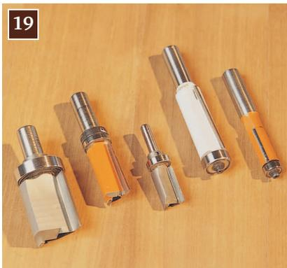
**Копировальные фрезы (слева направо):** диаметр 28 мм, длина режущей части 38 мм; диаметр 19 мм, длина режущей части 38 мм; диаметр 38 мм, длина режущей части 25 мм. Прямые кромочные фрезы: диаметр 19 мм, длина режущей части 50 мм; диаметр 12 мм, длина режущей части 25 мм.
