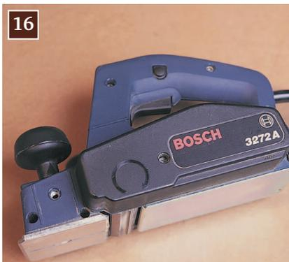
**16** Электрорубанок строгает древесину вращающимися ножами, расположенными под корпусом инструмента. Ручка-бобышка сверху регулирует глубину строгания. Быстрый проход срезает достаточно, для того чтобы превратить край заготовки в чистую кромку.
