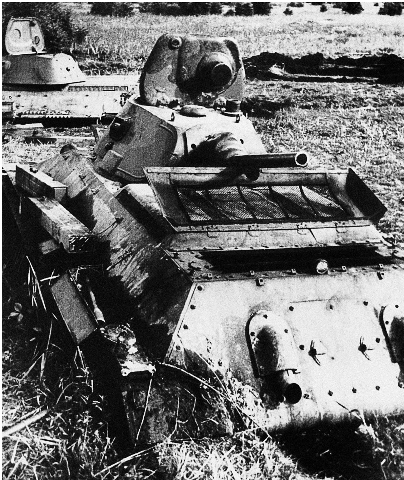
Танки Т-34, застрявшие в болотистой пойме реки Дзержинская у Толочина, рядом с автострадой Минск – Москва. Июль 1941 года. На переднем плане Т-34 с пушкой Л-11 выпуска 1940 года из состава танкового батальона Орловского бронетанкового училища. Обратите внимание, что машина имеет трехцветную камуфляжную окраску (РГАКФД).
