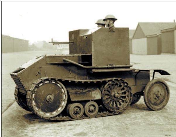
Танкетка «Моррис-Мартель» двухместного типа, мод. 1927 г.
