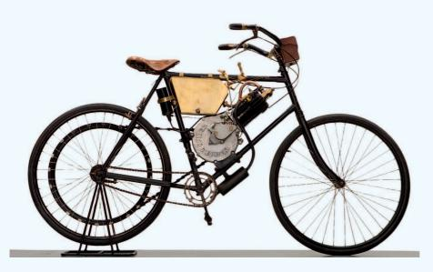
Наибольшую известность фирме Де Дион-Бутон принесли их новаторские автомобили и трехколесные велосипеды, но они также производили и моторы для мотоциклов, которые считаются первыми высокоскоростными двигателями внутреннего сгорания облегченного типа. Многие производители копировали дизайн и конструкцию этих двигателей, среди них и Harley-Davidson.
