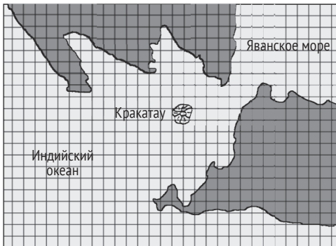
Рис. 1.9 Область дискретизирована на ячейки. Для каждой ячейки в вычислительной области такие свойства, как высота волны, скорость жидкости или плотность дыма, решаются в соответствии с физическими законами. В конечном счете стенсильная операция или матрично-векторная система представляет эту дискретную схему
