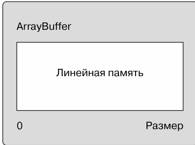
Рис. 2.5. ArrayBuffer используется модулями WebAssembly как линейная память
