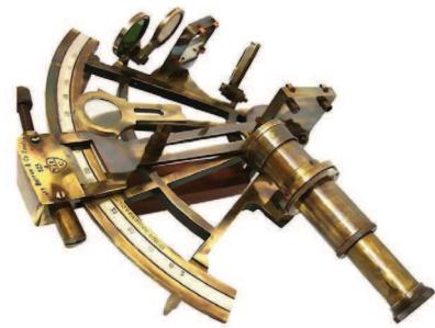
Секстант — прибор для измерения высоты Солнца и других небесных тел. С помощью секстанта определяли географическую широту.
