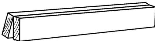
**Рис. 2. Как устанавливать бруски для промазывания клеем**
