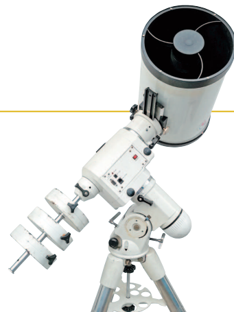
Телескоп НПЗ ТАЛ-250К на моторизированной монтировке Sky-Watcher EQ6
