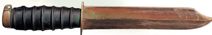
Штатный водолазный немагнитный нож
