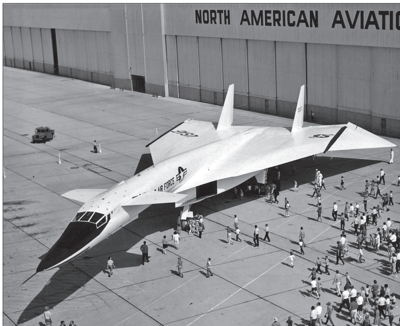
Сверхзвуковой бомбардировщик XB-70 «Валькирия». Для борьбы со смещением аэродинамического фокуса назад, при сверхзвуковом полете, были применены отклоняемые вниз внешние части крыла
