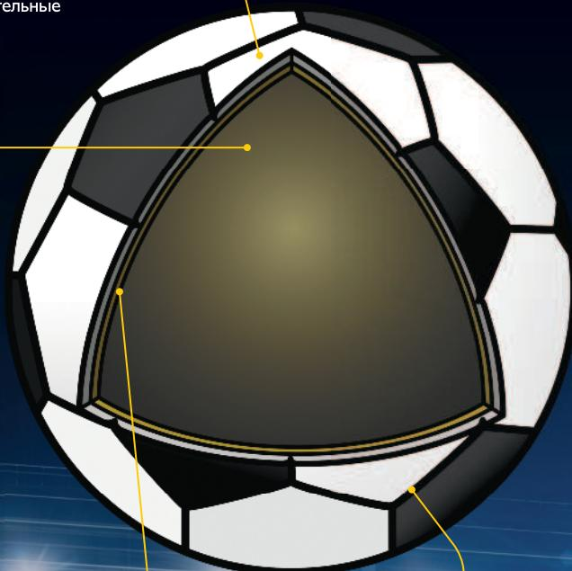
**Подкладка.** Находится между камерой и внешним покрытием. Подкладка влияет на упругость, форму, массу и другие характеристики мяча. Качественные подкладочные слои (которых в современных мячах четыре и более) делаются из нетканых материалов, например полизэстера
