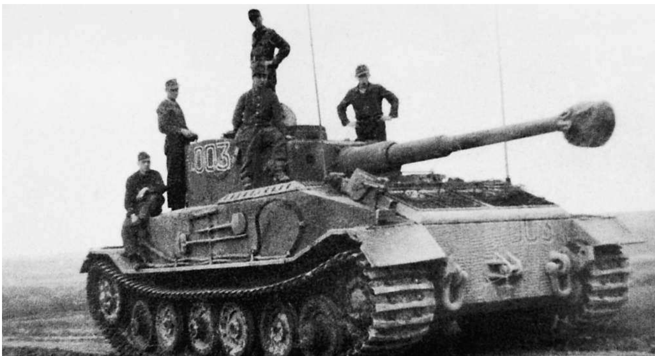
Танк «Тигр» Порше с гидравлической трансмиссией, использовавшийся в качестве командирской машины в 653-м тяжелом батальоне истребителей танков. Район Тернополя, июнь 1944 года (ИП).
