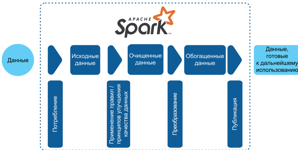
Рис. 1.5 Spark в обычном варианте обработки данных. Первый этап – потребление данных. На этом этапе исходные данные «сырые» (необработанные), возможно, далее потребуются применение некоторых методов улучшения качества данных (DQ). После этого данные готовы к преобразованию. После преобразования данные становятся «обогащенными». Наступает время их публикации или совместного использования, чтобы сотрудники вашей организации могли выполнять какие-либо действия с этими данными и принимать решения на их основе
