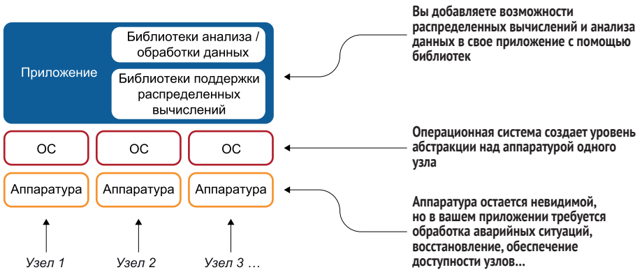
Рис. 1.2 Один из способов создания распределенных приложений, специализированных для обработки данных, – встраивание всех управляющих элементов на уровне приложения с использованием библиотек или других программных компонент. В результате размер приложений увеличивается и их сопровождение усложняется
