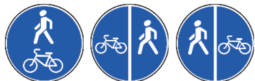
4.5.2 Пешеходная и велосипедная дорожка с совмещенным движением (велопешеходная дорожка с совмещенным движением); 4.5.4, 4.5.5 Пешеходная и велосипедная дорожка с разделением движения (велопешеходная дорожка с разделением движения)
